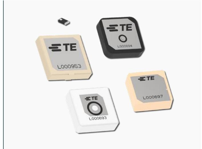
TE Connectivity (TE) のGNSS L1パッシブセラミックパッチアンテナおよびチップアンテナは、高性能、高信頼性、複数の実装オプションを提供する製品です。本製品は、1561MHz~1602MHzの様々な周波数帯域に対応しており、柔軟な設計が可能です。また、本製品は、最小レベルのGNSSアンテナの1つです。TEのISM 2.4 GHzおよび5.9GHzパッシブセラミックパッチアンテナは、ワイヤレスアプリケーションに高性能と高信頼性を提供します。
